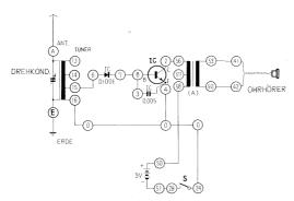
Anschlussanweisung: Antennendraht ANT-13, Erdleitung ERDE-16-0, 4-0, 24-0, 15-6, 7-8-3, 2-56, 58-50, 51-28, 59-41-ein Ohrhöreranschlussdraht, 60-42-zweiter Ohrhöreranschlussdraht. Anschluss der 9 V Batterie und Einschalten durch den Schalter.
