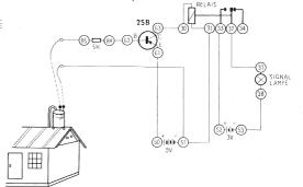
Anschlussanweisung: Eine Messfühleranschlussleitung-85, die andere-51-31, 84-62, 63-30, 61-50, 33-52, 53-38, 37-32. Anschluss von zwei 1,5 V Babyzellen und einer 9 V Batterie an die Schaltung.
