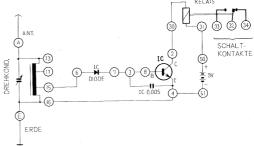
Anschlussanweisung: Antennendraht ANT-13, 15-6, 7-3-8, 2-30, 31-50. Erdleitung ERDE-16-4-51. Anschluss einer 9 V Batterie an die Batterieanschlusskontakte.
