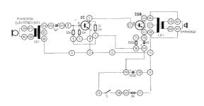
Anschlussanweisung: 39-67, 40-68, 64-113, 66-0, 4-5-0, 0-58-61-115-71, 0-119, 0-51, 2-62, 28-50, 112-8, 9-1-70-114-118-24, 63-56-41-ein Ohrhöreranschlussdraht, 58-42-zweiter Ohrhöreranschlussdraht. Anschluss der 9 V Batterie an die Batterieanschlusskontakte. Inbetriebnahme der Schaltung mit dem Schalter.
