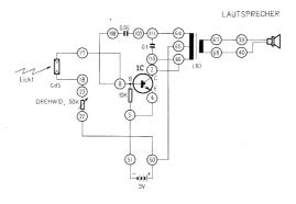
**Anschlussanweisung:** 17-8-108, 18-23, 22₅50-65, 4-5-51, 109-111-64, 2-66-110, 67-39, 68-40. Anschluss der 9 V Batterie an die Batterieanschlusskontakte.
