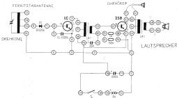
Anschlussanweisung: 16-0-4, 0-90, 0-119, 0-51, 0-64-42-ein Ohrhöreranschlussdraht, 15-6, 7-8-3, 2-56, 58-116-118-24, 28-50, 59-62, 117-60-81-91, 116-61-80, 66-63-41-zweiter Ohrhöreranschlussdraht, 68-39, 67-40. Anschluss einer 9 V-Batterie an die Batterieanschlusskontakte. Zum Einschalten Schalter schliessen.
