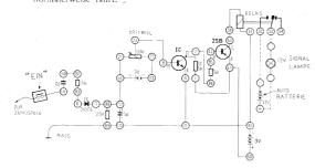
Anschlussanweisung: Schalter-111, 110-82, 83-6, 7-88-112-52-21, 22-53, 2-84, 62-85, 30-63, 1-61-50, 31-51-0-4, 0-113-89, 23-8, 89-Autokarosserie (Masse), 32-Signallampe (12 V), 33-ein Pol der Autobatterie (plus oder minus), anderer Pol der Autobatterie-Signallampe. Anschluss einer 9 V Batterie an die Batterieanschlusskontakte der Schaltung.
