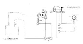
Anschlussanweisung: ein Ende der Leiterschleifean-8-92, das andere-51-4, 93-50-31, 2-30, 33-53, 32-ein Anschlusspunkt der Niederspannungsklingel, 52-zweiter Anschlusspunkt der Niederspannungsklingel. Anschluss einer 9 V Batterie an die Anschlusskontakte sowie zweier Babyzellen (å 1.5V) an den Batteriekasten.
