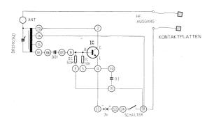
Anschlussanweisung: Eine Schockleitung ANT-13-2, 16-106- 107-8, 9-111-28-14, 28-zweite Schockleitung, 4-110, 5-4-53, 52-24. Einsetzen von zwei 1,5 V Babyzellen in den 3 V Batteriekasten. Zum Einschalten Schalter schliessen.
