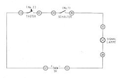
**Anschlussanweisung:** 54-52, 55-24, 28-37, 53-38. Einsetzen der beiden 1,5 V Babyzellen in den 3 V Batteriekasten.
