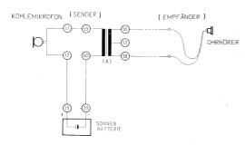
**Anschlussanweisung:** Eine Mikrofonanschlussleitung-11-59, die zweite-12-19, 60-20, 56-ein Ohrhöreranschluss, 58-der zweite Ohrhöreranschluss.
