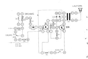
**Anschlussanweisung:** 53-22, 52-21-92-24, 93-26, 28-87, 23-84, 85-6, 86-9-4-51-65, 109-111-64, 110-66-63, 83-62-81-108, 2-82, 50-25, 1-80-61-27-29, 7-9, 67-39, 68-40, positive Eingangsleitung-93, die negative-86. Anschluss der 9 V Batterie und der zwei 1,5 Babyzellen an die entsprechenden Anschlusskontakte.
