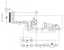
Anschlussanweisung: Antennendraht (1 m) ANT-13-2, 14-34-55-108-110, 16-106, 107-8, 31-32-9-109, 5-4-51-111, 4-30, 50-54. Anschluss der 9 V Batterie an die Batterieanschlusskontakte. Signalgabe erfolgt mit dem Taster.
