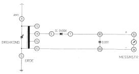
Anschlussanweisung: Antennendraht-ANT<sub>J</sub>13, 14-6, 7-102-35, Erdleitung ERDE-16-103-36. Diese Schaltung arbeitet nur, wenn starke Rundfunksignale vorhanden sind.
