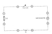
Anschlussanweisung: 17-54, 55-35, 18-52, 36-53. Einsetzen von zwei 1,5 V Babyzellen in den 3 V Batteriekasten.
