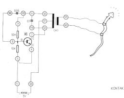
Anschlussanweisung 108-8, 4-5-51, 9-109-111-56, 57-50, 110-58-2, 59-eine Schockleitung, 60-zweite Schockleitung, Anschluss einer 9V Batterie an die Batterieanschlusskontakte
