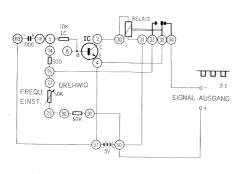
Anschlussanweisung: 119-51-4-32, 91-50-31, 23-90, 22-75-33, 118-5-74, 2-30, 34-negative Ausgangsleitung, 50-positive Ausgangsleitung. Anschluss der 9 V Batterie an ihre Anschlusskontakte.
