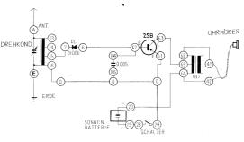
Anschlussanweisung: Antennendraht ANT-13, Erdlei tung ERDE-16-0, 105-0, 61-0, 24-0, 19-28, 6-62-104, 63-65, 66-41-ein Ohrhöreranschlussdraht, 20-64-42-zweiter Ohrhöreranschlussdraht. Sonnenbatterie dem Licht aussetzen!
