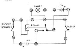
Anschlussanweisung: 24-30, 31-32-37-54, 33-51-55, 38-53, 52-34, 26-50. Die beiden 1,5 V Babygellen sind in den Batteriekasten einzusetzen. Der Rückstellschalter muss auf "Aus" stehen; durch Niederdrücken des Tasters wird die Schaltung in Betrieb genommen. Anstelle des Tasters kann auch ein Auslöseelement nach eigenem Entwurf an die Federkontakte 54 und 55 angeschlossen werden.
