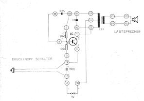
Anschlussanweisung: Eine Anschlussleitung des Druckknopfschalters (oder Tasters)-119-51, die zweite-118-5-4, 8-108, 109-9-111-64, 110-66-2, 65-50, 67-39, 68-40. Anschluss einer 9 V-Batterie an die entsprechenden Batterieanschlusskontakte des Baukastens. Versuch Nr. 150
