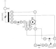
Anschlussanweisung: Antenne (1 m) ANT-13-2, 14-111-55, 16-106, 107-8, 9-111, 5-4-110, 4-51, 50-54. Anschluss einer 9 V Batterie an die entsprechenden Anschlusskontakte. Zum Senden, bzw. Signalgeben muss der Taster durch Niederdrücken geschlossen werden.
