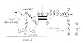
**Anschlussanweisung:** 54-59, 55-21, 41-106, 107-60-22, 42-23, 56-63, 57-53, 28-52, 61-24, 91-110-62, 90-111-58, ein Ende der zu bestimmenden Kapazität-41, das zweite Ende -55. Einsetzen von zwei 1,5 V Batterien in den 3 V Batteriekasten. Zum Messen Hauptschalter und Taster schliessen.
