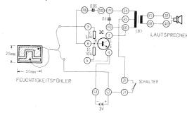
Anschlussanweisung: Eine Kontaktplatte-9, die zweite-52-24, 108-8, 5-4-53, 109-111-64, 110-66-2, 65-28, 67-39, 68-40. Einsetzen von zwei 1,5 V-Babyzellen in den 3 V-Batteriekasten. Einschalten mit dem Schalter.
