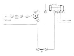
Anschlussanweisung: Positive Eingsleitung-71, negative Eingangsleitung-4-51, 70-8, 2-30, 31-50. Anschluss einer 9 V Batterie an die Batterieanschlusskontakte.
