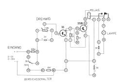
Anschlussanweisung: 21-52-92-24, 93-26, 28-87, 23-8, 22-53, 86-0, 4-0, 51-31-0, 2-84, 62-85, 1-61-50, 33-53, 32-37, 52-38, 30-63, positive Eingangsleitung-93, die negative-86. Anschluss der beiden 1,5 V Batterien sowie der 9 V Batterie an ihre jeweiligen Kontaktstellen. Mit dem Schalter kann der Arbeitsbereich für das Warnsignal umgeschaltet werden.
