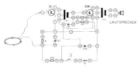
Anschlussanweisung: Ein Leiterschleifenende des Empfängers-8, 2-56, das andere Leiterschleifenende 83-93, 83-114, 82-0-115, 0-4, 0-90, 0-64, 0-119, 0-51, 28-50, 92-24-118-116-58, 116-61-80, 117-60-81-91, 59-62, 63-66, 68-39, 67-40. Anschluss einer 9V Batterie an die Batterieanschlusskontakte. Zum Einschalten Schalter schliessen.
