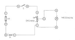
Anschlussanweisung: 17-24, 28-22, 18-50, 51-21-36, 23-35. Anschluss einer 9 V Batterie an die Anschlusskontakte und Inbetriebnahme mit dem Schalter.
