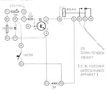
**Anschlussanweisung:** 22-80, 23-9-116-54, 81-117-4-51, 55-50-31, 2-30. Anschluss einer 9 V Batterie an die Batterieanschlusskontakte.
