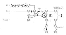
Anschlussanweisung: HF-Eingangsleitung-106, NF-Eingangsleitung-111, 107-6, 7-110-8-102, 10-2-41-ein Ohrhöreranschlussdraht, 1-42-zweiter Ohrhöreranschlussdraht, 24-42, Masseleitungen von HF-und NF-Eingängen ERDE-103-4-51, 50-28. Anschluss der 9 V Batterie an ihre Kontakte. Inbetriebnahme durch Einschalten des Schalters.
