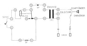
**Anschlussanweisung:** 54-30, 31-32-112, 113-59, 60-34-51, 50-55, 56-ein Ohrhöreranschluss, 58-Erde, zweiter Ohrhöreranschluss-Erde. Anschluss der 9V Batterie an die Batterieanschlusskontakte. Signalgabe durch Niederdrücken des Tasters.
