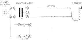
Anschlussanweisung: Ein Mikrofonanschlussdraht-11-59, der zweite-12-24, 28-53, 52-60. Ein Ohrhöreranschlussdraht-56, der zweite-58. Es werden zwei 1,5 V Batterien (3 V Batteriekasten) benötigt. Zum Betrieb muss der Schalter eingeschaltet werden; anschliessend Ausschalten nicht vergessen!
