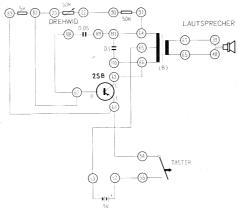
**Anschlussanweisung:** 83-61-54, 23-82-62-108, 22-90, 109-111-64-91, 110-66-63, 65-53, 52-55, 67-39, 68-40. Anschluss der 9 V-Batterie an die entsprechenden Batterieanschlusskontakte.
