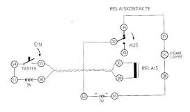
Anschlussanweisung: 54-51, 55-31, 50-30, 52-32, 34-37, 53-38. Einsetzen der beiden 1,5 V Babyzellen in den 3 V Batteriekasten und Anschliessen der 9 V Batterie an die Batterieanschlusskontakte.
