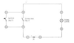
Anschlussanweisung: 55-28-37, 54-24-52, 53-38. Einsetzen der beiden 1,5 V Babyzellen in den 3 V Batteriekasten.
