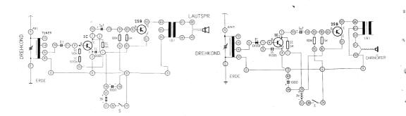
Anschlussanweisung: Antennendraht ANT-13, 15-110, 111-8, Erdleitung ERDE-16-0, 4-0, 0-119, 0-92, 0-24, 66-0, 10-1-82-61, 1-118-50, 51-28, 112-2-3, 113-93-83-62, 63-64, 67-39, 68-40. Anschluss der 9 V Batterie an die Batterieanschlusskontakte. Einschalten mit Hilfe des Schalters.
