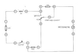
Anschlussanweisung: 51-17, 18-54, 55-74-36, 75-26, 24-80-35, 50-28-81. Anschluss einer 9 ♥ Batterie an die entsprechenden Anschlusskontakte. Zum Messen muss der Taster geschlossen werden. Ist der Zeigerausschlag zu gross oder zu klein, kann auf den anderen Messbereich umgeschaltet werden.
