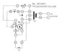
Anschlussanweisung: 22-5, 108-8, 4-9-53, 52-65, 110-66-2, 109-111-64-23, 67 Ausgangsleitung Nr. 1,68-Ausgangsleitung Nr. 2 Einsetzen von zwei 1.5 V Babyzellen in den 3 V-Batteriekasten.
