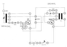
**Anschlussanweisung:** Antennendraht (1 m) ANT-13-2, 14-3-9, 3-59, 16-106, 107-8, 5-4-57, 4-51, 50-54-60, 23-108-62, 109-111-56-79, 22-78, 110-58-63, 55-61. Anschluss der 9 V Batterie an ihre Anschlusskontakte. Die Signalauslösung erfolgt durch Niederdrücken des Tasters.
