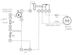
Anschlussanweisung: 17-8, 2-30, 18-23, 22-50-31, 4-51, 32-ein Pol der Autobatterie, anderer Pol der Autobatterie Scheinwerferlampe, Fernlichtanschluss der Scheinwerferlampe-34, Abblendlichtanschluss-33, Anschluss einer 9 V Batterie an die Batterieanschlusskontakte des Baukastens.
