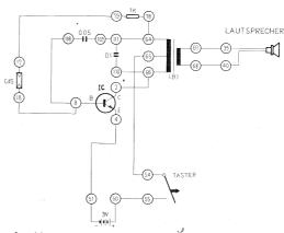
Anschlussanweisung: 17-79, 78-64-1111-109, 18-8-108, 110-66-2, 65-54, 4-51, 50-55, 67-39, 68-40. Anschluss der 9 V Batterie an die Anschlusskontakte und Schliessen des Tasters zum Einschalten.
