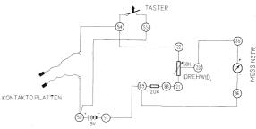
Anschlussanweisung: Anschlussleitung der einen Kontaktplatte-54-22, Anschlussleitung der anderen Kontaktplatte-50-55, 51-89-36, 88-21, 23-35. Anschluss einer 9 V Batterie an die Batterieanschlusskontakte.
