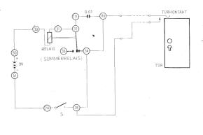
Anschlussanweisung: 51-24, 50-30, 31-32-111, 28-34-110, eine Türkontaktanschlussleitung-110, die zweite-28. Anschluss einer 9 V Batterie an ihre Anschlusskontakte. Zum Einschalten Schalter schliessen.
