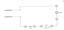
Anschlussanweisung: 52-24, 28-38. Eine Prüfleitung-53, die zweite-37. Zum Prüfen müssen die Prüfleitungen mit ihren abisolierten Enden an die zu prüfende Schaltung gehalten werden; der Schalter muss hierbei geschlossen sein. Wenn die Schaltung ordnungsgemässen Durchgang hat, leuchtet die Lampe auf.
