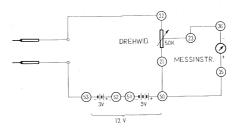
Anschlussanweisung: Ein Ende der einen Prüfleitung-22, ein Ende der anderen-53, 52-51, 21-50-35, 23-36, Anschluss von zwei 1,5 V Babyzellen an den Batteriekasten sowie der 9 V Batterie an die Anschlusskontakte.
