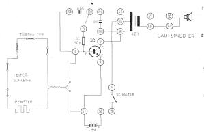
**Anschlussanweisung:** Ein Ende der Leiterschleife-8-108, das andere Ende-51-4 9-109-111-64, 2-66-110, 24-65, 50-28,  $67^{5}$ 39, 68-40. Anschluss einer 9 V Batterie an die Batterieanschlusskontakte. Zum Einschalten Schalter schliessen.
