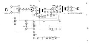
**Anschlussanweisung:** Eine Mikrofonleitung-11-22, 11-78, die zweite Mikrofonleitung-12-21-0-4, 0-82, 0-90, 51-119-0, 0-64, 0-115, 79-87-83-114, 86-24-118-116-58, 116-61-80, 23-8, 2-56, 117-60-81-91, 59-62, 28-50, 63-66, 68-39, 67-40. Anschluss der 9 V Batterie an ihre Kontakte und Einschalten mit dem Schalter.
