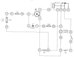
Anschlussanweisung: 17-81, 18-50-31, 80-8-6, 7-88, 2-30, 4-51-53-38, 89-37-33, 24-32, 52-28. Anschluss der 9 V und der beiden 1,5 V Batterien an die Anschlusskontakte. Inbetriebnahme der Schaltung durch den Schalter.
