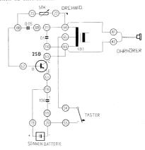
Anschlussanweisung: 23-108-62, 109-111-64-41-ein Ohrhöreranschlussdraht, 64-22, 110-66-63, 66-42-zweiter Ohrhöreranschlussdraht, 65-54, 61-116-19, 117-20-55. Die Sonnenbatterie muss dem Licht gut ausgesetzt sein; evtl ist Zusatzbeleuchtung erforderlich.
