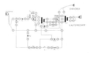
Anschlussanweisung: Eine Mikrofonanschlussleitung-11-78-112, die zweite-12-0-115, 0-4, 0-90, 0-119, 0-51, 0-64-42-ein Ohrhöreranschlussdraht, 113-8, 79-83-114, 82-24-118-116, 61-80, 58-116, 10-2-56, 117-60-81-91, 59-62, 66-63-41-zweiter Ohrhöreranschlussdraht, 68-39, 67-40, 28-50 Anschluss einer 9 V-Batterie an die Batterieanschlusskontakte.
