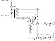
Anschlussanweisung: Antennenleitung (ca. 1 m) ANT-13-2, 14-111-55-93, 16-106, 107-8, 9-92, 5-4-110, 4-negative Anschlussleitung der 9 V oder 12 V Batterie, 54-positive Anschlussleitung der Batterie. Zum Signalgeben muss der Taster durch Niederdrücken geschlossen werden.
