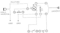
Anschlussanweisung: Eine Mikrofonleitung-8-78, 79-1-42-ein Ohrhöreranschluss, 2-41-zweiter Ohrhöreranschluss, 4-24, 28-53, eine Mikrofonleitung-Erde, 42-52, 4-Erde. Einsetzen von zwei 1,5 V-Babyzellen in den Batteriekasten, Inbetriebnahme mit dem Schalter.
