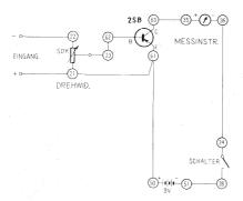
Anschlussanweisung: Negative Eingangsleitung-22, positive Eingangsleitung-21-61-50, 62-23, 63-35, 36-24, 28-51, Anschluss einer 9 V Batterie an die Anschlusskontakte. Inbetriebnahme der Schaltung durch den Schalter.
