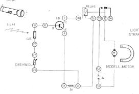
Anschlussanweisung: 18-8, 17-22, 23-50-31, 4-51, 2-30, 33-53, 32-eine Anschlussleitung des zu schaltenden Gegenstandes, 52-zweite Anschlussleitung. Anschluss der 9 V Batterie und der beiden 1,5 V Batterien an ihre Anschlusskontakte.
