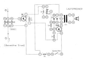
Anschlussanweisung: 70-72-74-8, 71-73-75-4-51-65, 2-53-21, 52-22, 23-82, 1-80-61-28, 109-111-64, 108-62-81, 83-62, 110-66-63, 50-24, 67-39, 68-40, positive Eingangsleitung-72, die negative-73. Anschluss der 9 V Batterie sowie der beiden 1,5 V Babyzellen. Inbetriebnahme der Schaltung durch den Einschalter.
