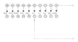
Anschlussanweisung: 100-102-104-106-108-110-112-114-116-118-ein Ende einer langen Prüfleitung. Eine zweite Prüfleitung ist an das andere Ende des gewünschten Kondensators anzuschliessen.
