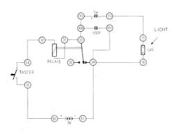
Anschlussanweisung: 54-30, 31-32-100-112, 113-17, 101-34-18, 34-51, 55-50. Anschluss einer 9 V-Batterie an die entsprechenden Anschlusskontakte. Zur Inbetriebnahme muss der Taster geschlossen werden, der bei Bedarf auch durch einen normalen Schalter ersetzt werden kann.
