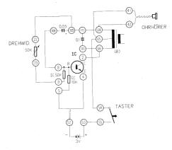
Anschlussanweisung: 22-109-111-64-42-ein Ohrhöreranschlussdraht, 23-9, 108-8, 5-52-4, 53-55, \$4-65,41-zweiter Ohrhöreranschlussdraht, 110-66-2. Einsetzen von zwei 1.5V Babyzellen in den Batteriekasten.
