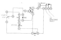
**Anschlussanweisung:** 28-86, 24-8-118, 87-23, 22-50-31, 2-30, 119-4-51-26. Anschluss einer 9  $V^J$  Batterie an die Schaltbrettkontakte.
