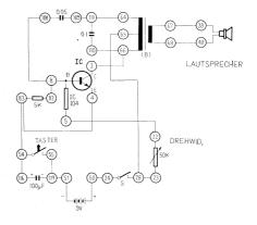
Anschlussanweisung: 108-8-82, 116-54;83-4, 55-117-51, 50-24, 23-28-65, 22-5, 109-111-64, 110-66-2, 67-39, 68-40. Anschluss einer 9 V Batterie an die Batterieanschlusskontakte. Zum Auslösen der Laute den Taster durch Niederdrücken schliessen.
