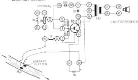
Anschlussanweisung: Eine Messfühleranschlussleitung: 77-\$2-52, die andere-50-65, 53-21, 23-9, 8-108, 109-111-64, \$10-66-2, 76-5-4-51, 67-39, 68-40. Anschluss einer 9 V Batterie an die Batterieanschlusskontakte des Baukastens. Versuch Nr. 144
