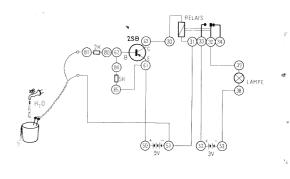
Anschlussanweisung: Eine Prüfleitung-81, 80-62-84, zweite Prüfleitung-51-31, 85-61-50, 63-30, 33-52, 32-37, 38-53. Anschluss einer 9 V Batterie an die Batterieanschlusskontakte und Einsetzen von zwei 1,5 V Babyzellen in den 3 V Batteriekasten.
