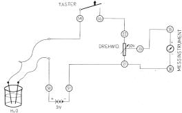
Anschlussanweisung: ein langer Draht mit abisolierten Enden-50, ein gleicher zweiter-54, 23-36, 55-22, 51-21-36. Anschliessen der 9 V Batterie an die Batterieanschlusskontakte. Zum Messen müssen die freien Enden der langen Drähte in die betreffende Flüssigkeit eingetaucht werden; sie dürfen einander jedoch hierbei nicht berühren. Bei gedrücktem Taster kann dann die beschriebene Einstellung des Drehwiderstandes auf "5" erfolgen.
