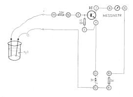
Anschlussanweisung: Eine Prüfleitung § 9, 88-8, 5-4-53, 2-36, 35-80, zweite Prüfleitung 52-81. Einsetzen von zwei 1,5 V Babyzellen in den Batteriekasten.
