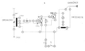
Anschlussanweisung: Antennendraht-ANT-13, 15-6, 7-3-8, 2-62, 63-35, 61-1-50, 36-65, 66-42-ein Ohrhöreranschlussdraht, 51-28, Erdleitung ERDE-16-0-4-24-41-64-zweiter Ohrhöreranschlussdraht. Anschluss der 9 V Batterie an die Anschlusskontakte. Einschalten durch den Schalter.
