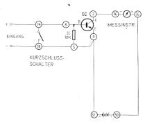
**Anschlussanweisung:** Positive Eingangsleitung-24-8, negative Eingangsleitung-28-5-4-51, 2-36, 35-50. Anschluss der 9 V Batterie an die Anschlusskontakte.
