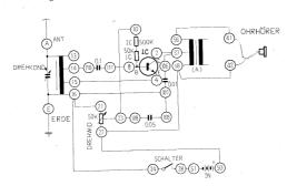
Anschlussanweisung: Antennendraht ANT-13, 14-110, 15-4, Erdleitung ERDE-16-107-109, 24-16-21, 10-23-108, 28-51, 50-22-58-42-ein Ohrhöreranschlussdraht, 2-57-106, 56-41-zweiter Ohrhöreranschlussdraht, 111-8, Anschluss der 9 V Batterie an ihre Kontakte und Einschalten mit dem Schalter.
