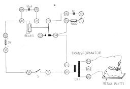
Anschlussanweisung: 114-30-50, 115-31-32-110, 111-71, 70-34-67, 28-68, 51-24, 64-eine Schockleitung, 66-zweite Schockleitung. Anschluse einer 9 V Batterie und zum Einschalten Schalter schliessen.
