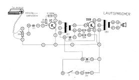
**Anschlussanweisung:** Ein Ohrhöreranschlussdraht-22, der zweite-21-0, 4-0, 0-90, 0-119, 0-51, 0-64, 23-110, 111-8, 10-2-56, 58-116-118-24, 116-61-80, 117-60-81-91, 59-62, 63-66, 28-50, 68-39, 67-40. Anschluss der 9 V Batterie an die Anschlusskontakte. Einschalten der Schaltung mit dem Schalter.
