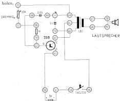
Anschlussanweisung: 23-64-111-109, 108-62-79, 22-78, 110-66-63, 61-50, 51-54, 55-65, 67-39, 68-40. Anschluss der 9 V Batterie an ihre Anschlusskontakte. Der Ton wird mit dem Taster ausgelöst.
