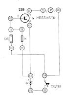
Anschlussanweisung: 62-17-78, 18-54-36, 79-52-61, 53-55, 63-35. Anschluss von zwei 1,5 V Babyzellen im Batteriekasten. Zum Messen muss der Taster durch Niederdrücken geschlossen werden.
