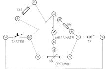
Anschlussanweisung: 54-50, 18-55-21, 17-35-86, 87-51-22, 36-23, Anschluss der 9 V Batterie an ihre Anschlusskontakte. Zum Messen muss der Taster niedergedrückt werden.
