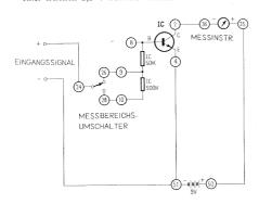
Anschlussanweisung: Positive Eingangsleitung-24, negative Eingangsleitung-51-4, 26-9, 28-10, 2-36, 35-50. Anschluss der 9 V Batterie an die entsprechenden Anschlusskontakte.
