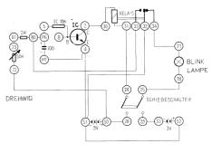
Anschlussanweisung: 23-81, 22-50-28, 29-53, 52-51-4-117, 51-32, 5-116-80-33, 2-30, 31-24, 25-38, 37-34, Anschluss der 9 V Batterie und der zwei 1,5 V Babyzellen an ihre jeweiligen Anschlusspunkte. Der Schalter dient zum Einbzw. Ausschalten des Schaltkreises.
