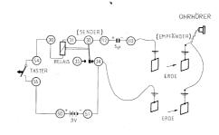
Anschlussanweisung: 54-30, 31-32-112, 55-50, 51-34-Erde, 113-Erde, Anschluss des Ohrhörers an zwei voneinander unabhängige Erdleiter. Anschluss der 9 V-Batterie an ihre Anschlusskontakte. Die Signalgabe erfolgt durch Niederdrücken des Tasters.
