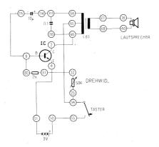
Anschlussansweisung: 115-8-80, 81-22, 4-51, 23-54-65, 114-111-64, 110-66-2, 50-55, 67-39, 68-40. Anschluss einer 9 V Batterie an die Batterieanschlusskontakte. Zur Inbetriebnahme Taster durch Niederdrücken schliessen.
