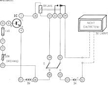
Anschlussanweisung: 18-8, 17-22, 23-50<sub>2</sub>28, 4-51, 2-30, 24-31, 25-32, 29-53, 52-eine Anschlussleitung des Warnzeichens, 34-zweite Anschlussleitung. Anschluss einer 9 V und zweier 1,5 V Batterien an die entsprechenden Batterie-kontaktstellen.
