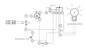
Anschlussanweisung: 17-8, 54-18-33, 55-50-32-53, 2-30, 4-51, 34-Alarm-Signal, 52-Alarm-Signal, 31-50, Anschluss einer 9 V Batterie und von zwei 1.5 V Babyzellen an ihre zugehörigen Anschlusskontakte.
