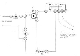
Anschlussansweisung: Eine Signal (NF)-anschlussleitung -6, 7-8-112, die zweite-113-51-4, 2-30, 50-31, 33-ein Anschluss des zu schaltenden Objektes, 32-die andere Anschlussleitung des zu schaltenden Objektes. Anschluss der 9 V Batterie an die Anschlusskontakte.
