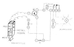
Anschlussanweisung: 89-50-31, 4-51, 2-30, 33-53, 52eine Anschlussleitung der Alarmglocke, 32-andere Anschlussleitung der Alarmglocke, 8-eine Metallfeder des Alarmauslösers, 88-andere Seite des Alarmauslösers. Anschluss von zwei 1,5 V Babyzellen und einer 9 V Batterie an den Baukasten. Versuch Nr. 138
