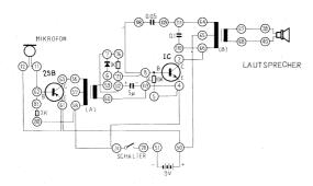
**Anschlussanweisung:** Eine Mikrofonanschlussleitung-12-61-50-65, die zweite-11-62-81, 80-58-24-4-113-60, 4-5, 76-7-112, 77-8-108, 6-59, 63-56, 109-111-64, 110-66-2, 28-51, 67-39, 68-40. Anschluss einer 9 V Batterie an die Batterieanschlusskontakte. Zum Einschalten Schalter schliessen.
