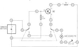
Anschlussanweisung: 19-25, 29-8, 2-50, 51-55-20-9, 4-28, 24-35, 36-54, 27-26. Anschluss der 9 V Batterie. Zum Messen muss der Taster geschlossen werden.
