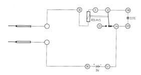
Anschlussanweisung: Langer Draht mit abisolierten Enden-30, ein gleicher zweiter-50, 31-32-108, 51-34-109. Anschluss der 9 V Batterie an die entsprechenden Batterie-kontakte. Zum Prüfen müssen die abisolierten Enden der beiden langen Drähte an die fraglichen Stellen gehalten
