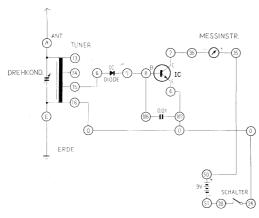
Anschlussanweisung: Antennendraht-ANT-13, 15-6, 7-8-106, 2-36, 35-50, 51-28, Erdleitung ERDE-16-0-4-107-24. Anschluss der 9 V Batterie an ihre Kontakte. Inbetriebnahme durch den Schalter.
