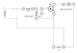
Anschlussanweisung: Ein Anschlussdraht des Prüfobjektes-95, 94-22, 21-4-51, 23-8, 2-36. Zweiter Anschlussdraht des Prüfobjektes-50-35. Anschluss der 9 V Batterie an die entsprechenden Kontakte.
