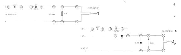
Anschlussanweisung: Eine HF-Eingángsleitung-101, die zweite -103-94-42-ein Ohrhöreranschlussdraht, 100-6, 7-102-95-41-zweiter Ohrhöreranschlussdraht. Das Ausgangssignal wird im Ohrhörer hörbar.
