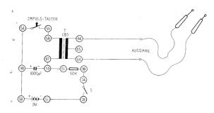
Anschlussanweisung: 54-118-50, 55-68, 67-119-91, 90-24, 51-28, 66-eine Schockleitung, 64-zweite Schockleitung, Anschluss einer 9 V Batterie an die Batterieanschlusskontakte. Auslösen des Impulses durch Niederdrücken des Tasters.
