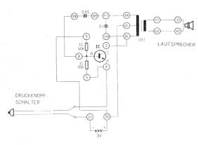
Anschlussanweisung: Eine Anschlussleitung des Druckknopfschalters-51, die zweite-4-5, 108-8, 9-50-65, 2-66-110, 109-111-64, 67-39, 68-40. Anschluss einer 9 V-Batterie an die Anschlusskontakte.
