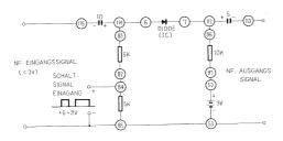
Anschlussanweisung: Eine Eingangsleitung-115, die zweite 85-53-eine Ausgangsleitung. 83-114-6, 7-112-86, Schaltereingangsleitung-84-82, 52-87, 113-zweite Ausgangsleitung. Einsetzen von zwei 1.5 V Babyzellen in den 3 V Batteriekasten.
