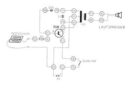
Anschlussanweisung: Eine Kontaktplattenleitung-84, die zweite-53-65, 85-62-108, 109-111-64, 63-66-110, 61-28, 52-24, 67-39, 68-40. Einsetzen von zwei 1,5 V-Babyzellen in den 3 V-Batteriekasten. Zum Einschalten Schalter schliessen.
