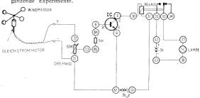
Anschlussanweisung: Positive Generatorleitung-22, negative Generatorleitung-21-51-4, 2-30, 8-84, 23-85, 50-31, 33-52, 32-37, 53-38. Anschluss von zwei 1,5 V Babyzellen und einer 9 V Batterie an ihre jeweiligen Anschlusstellen.
