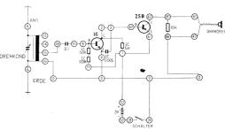
Anschlussanweisung: Antennendraht ANT-13, 15-110, Erdleitung ERDE-16-0, 4-0, 24-0, 86-0, 86-42-ein Ohrhöreranschlussdraht, 10-1-61, 1-52, 53-28, 111-8, 2-3-62, 63-87-41-zweiter Ohrhöreranschlussdraht. Einsetzen von zwei 1,5 V Babyzellen in den Batteriekasten und Einschalten mit dem Schalter.
