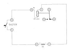
Anschlussanweisung: 54-30, 31-51, 55-50. Anschluss der 9 V Batterie an die Anschlusskontakte. Zum Morsen muss der Taster niedergedrückt werden.
