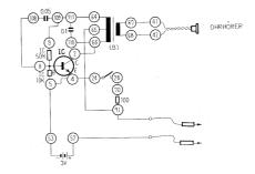
Anschlussanweisung: 53-5-4-24, 8-108, 9-109-111-64, 2-66-110, 65-71-ein Ende der einen Prüfleitung. Ein Ende der anderen Prüfleitung-52, 28-70, 67-41-ein Ohrhöreranschlussdraht, 68-42-zweiter Ohrhöreranschlussdraht. Einsetzen von zwei 1,5 V Babyzellen in den 3 V Batteriekasten.
