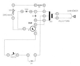
Anschlussanweisung: 23-82, 82-64-111-109, 108-62-22, 110-66-63, 61-54, 55-52, 53-65, 67-ein Ohrhöreranschlussdraht, 68-zweiter Ohrhöreranschlussdraht. Einsetzen von zwei 1,5 V-Babyzellen in den Batteriekasten. Signalgabe mit dem Taster.
