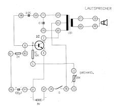
**Anschlussanweisung:** 108-8-80, 81-116, 117-51-4, 50-24, 23-28-65, 22-5, 2-66-110, 109-111-64, 67-39, 68-40. Anschluss einer 9 V Batterie an die Batterieanschlusskontakte. Einschalten mit dem Schalter.
