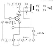
**Anschlussanweisung:** 113-8-80, 81-116, 117-51-4, 2-66-110, 112-111-64, 50-24, 23-28-65, 9-22, 67-39, 68-40. Anschluss der 9 V Batterie an die Anschlusskontakte; Inbetriebnahme der Schaltung mit dem Schalter.
