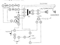
Anschlussanweisung: 23-62-108, 22-82, 83-111-109, 111-64-ein Ohrhöreranschlussdraht, 26-65-zweiter Ohrhöreranschlussdraht, 110-66-63, 61-54-37, 38-27, 53-24, 55-52, 67-39, 68-40. Einsetzen von zwei 1,5 V-Babyzellen in den 3 V-Batteriekasten. Signalauslösung durch Schliessen des Tasters; Signalwahl (Licht oder Ton) mit dem Schalter.
