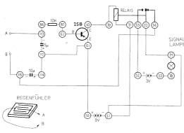
Anschlussanweisung: Eine Kontaktplattenleitung-113-86, die zweite-115-34, 114-112-61-50, 63-30, 51-37-32, 51-31, 87-62, 52-33, 53-38. Anschluss einer 9 V Batterie und zwei 1,5 V Babyzellen an den Baukasten.
