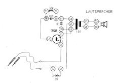
Anschlussanweisung: Langer Draht mit abisolierten Enden-61, ein zweiter gleicher-52, 91-108-62, 90-109-111-64, 110-66-63, 53-65, 68-40, 67-39. Einsetzen der beiden 1,5 V Babyzellen in den 3 V Batteriekasten. Diese Schaltung arbeitet nur mit Widerständen, die kleiner sind als  $200\Omega$ . Versuch Nr. 20
